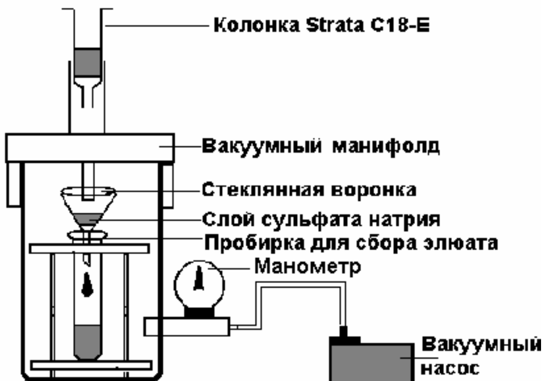
Схема установки для твердофазной экстракции бенз(а)пирена
